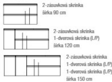
Detail bočného modulu MUM
